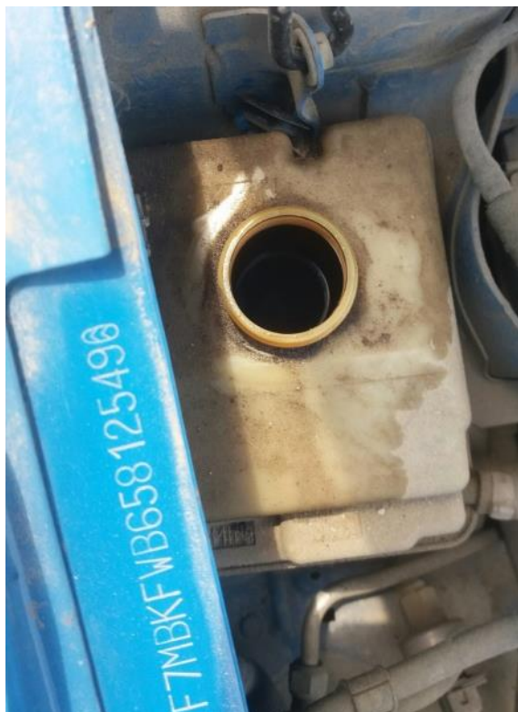
Παραμονή υγρού ψυγείου στο δοχείο πλήρωσης μετά την απορρύπανση
