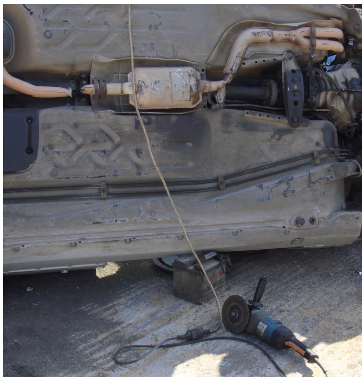
Κοπή καταλύτη με μη εγκεκριμένο κόφτη και χρήση συσσωρευτή σαν σφήνα !
